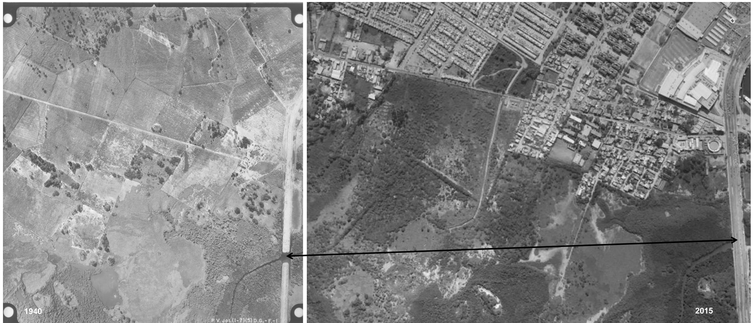
Figura 80. Zona del estero El Salado, donde la presión urbana ha ido construyendo edificaciones esta zona hidrológicamente baja, afectando su dinámica hidrológica y generando nuevas zonas de inundación en su periferia. Estas urbanizaciones pueden ser afectadas por hundimientos dado que se asientan sobre un suelo formado por arcillas, limos y arenas, con un nivel freático muy cercano a la superficie, Estas características en caso de un sismo también puede generar licuefacción y afectarlas.
