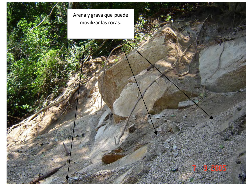
Figura 46. En las siguientes fotografías se aprecian las características de las rocas inestables en la cima y ubicadas dentro del nicho del desprendimiento, su estado de equilibrio muy reducido y ubicado en una ladera de alta pendiente.
