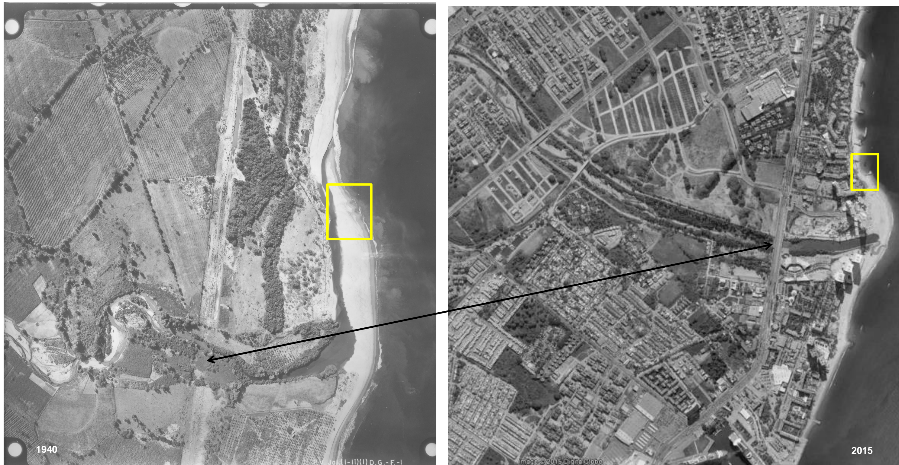
Figura 83. Desembocadura del río Pitillal, la cual ha sido modificada totalmente con la construcción de edificaciones en sus márgenes. Se puede observar el amplio delta que existía en 1940 y como ahora es más reducido y más convexo, en el cual se han construido grandes hoteles, edificaciones para uso compartido y apartamentos, edificados sobre depósitos de arena en el litoral. Obsérvese la reducción de la superficie de la playa en la imagen del 2015. La zona marcada con el recuadro amarillo es donde ocurrió en el 2014 un hundimiento de playa en el área del Hotel Hollyday Inn (ver figura 53).
