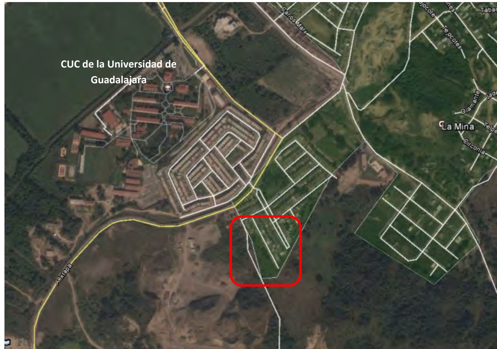
Figura 49. El recuadro rojo señala la ubicación donde se han presentado problemas por hundimientos en el norte de Puerto Vallarta, afectándose edificaciones recientes construidas sobre suelos limo-arenosos y un nivel freático muy superficial.
